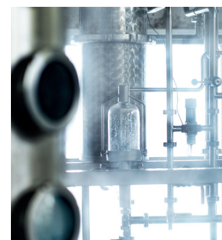
Up-scale distillation units for the concentration of flavouring components. Destillationseinheiten für die Konzentration geschmacksgebender Komponenten
