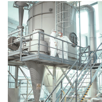
Spray drying for the production of high-quality granulates and powders. Sprühtrocknung für die Produktion hochwertiger Pulver und Granulate
